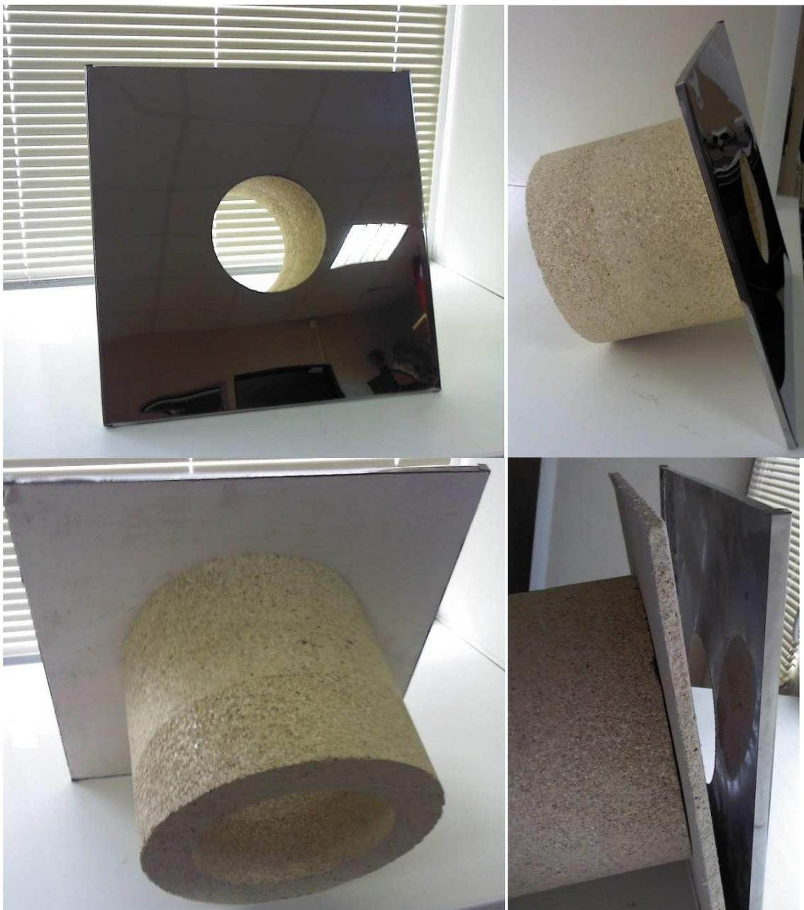
Данный вспомогательный узел представляет из себя фланец, изготовленный из нержавеющей стали с вкладышем из СМЛ(стекломagneзитовый лист) в сочетании с гильзой, выполненной из вермикулита. В данном исполнении узел обладает значительным рассеивающим эффектом, способным погасить достаточные высокие тепловые нагрузки. Дополнительно, для закрытия сверху, узел или ППУ может комплектоваться фланцем без вермикулитовой гильзы.
